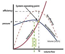
هرفن منحنی عملکرد ویژه خود را دارد ، که بستگی به نوع فن ، شکل پروانه ، تعداد پروانه ها و مشخصات موتور آن دارد.برای مشخص کردن نقطه عملکرد فن ، ابتدا فشار استاتیک را محاسبه کرده و سپس مقدار آن را در محور سمت چپ مشخص کنید. یک خط افقی از این مقدار فشار رسم کرده و تقاطع آن را با منحنی عملکرد تعین کنید. حال یک خط عمودی از نقطه تقاطع تا محور افقی پایین رسم کنید تا مقدار هوادهی در آن فشار معین بدست آید.
